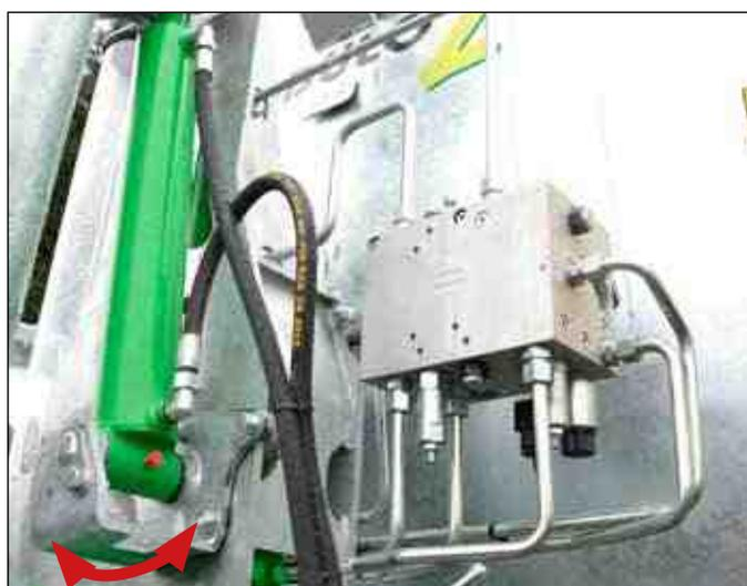
Per cambiare lato, la base del pistone idraulico deve solo essere spostato da destra a sinistra
