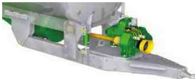
Trasmissione meccanica delle 2 pompe tramite scatola di trasmissione
