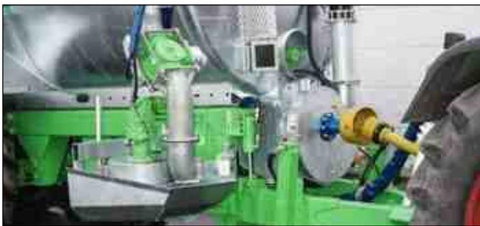
Dual-Storm con azionamento idraulico della pompa spargitrice
