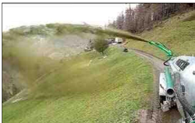
Regolazione verticale della pistola spargitrice tramite cilindro idraulico (in opzione)
