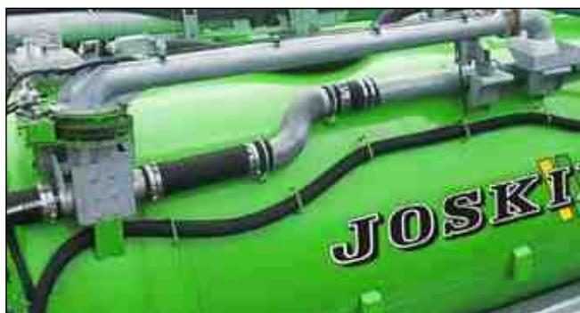
Il braccio di scarico Ø 8 "è un altro modo per trasferire il liquame. Consente all'autocisterna di trasporto di alimentare un'inferriera o una spanditrice attraverso un'uscita superiore.
