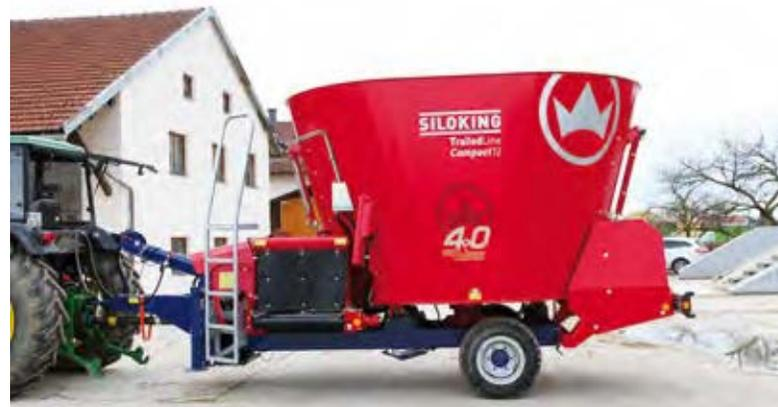
Nastro trasportatore trasversale nella parte anteriore e porta di scarico nella parte posteriore centrale.
