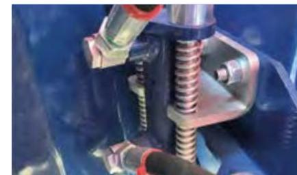
Cambio a 2 velocità con comandi idraulici.
