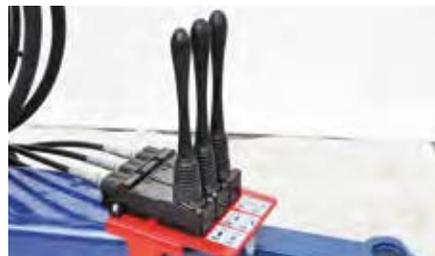
Controllo delle funzioni tramite cavo teleflessibile.
