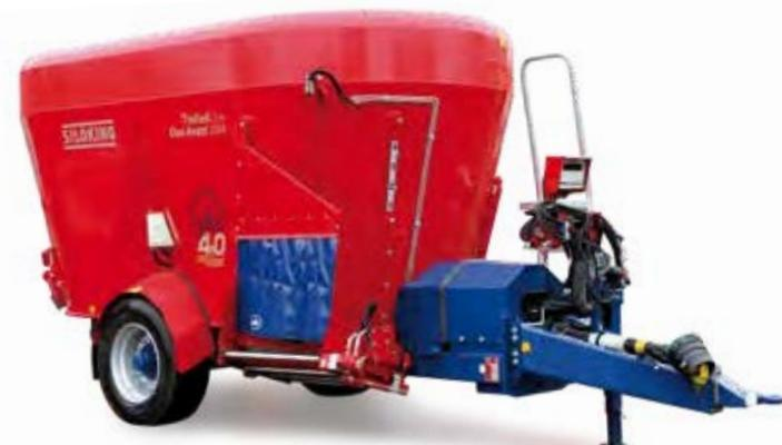
Porta di scarico anteriore destra con catena di scarico allungabile (opzionale).
