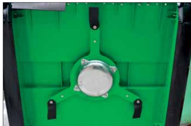
I tritratore BEV sono dotati di un rotore che supporta 3 lame del "tipo TD"
