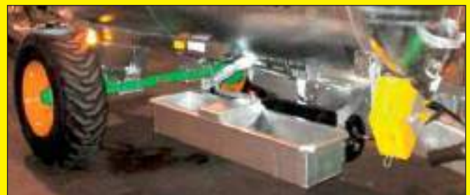
Abbeveratoio laterale a livello costante
