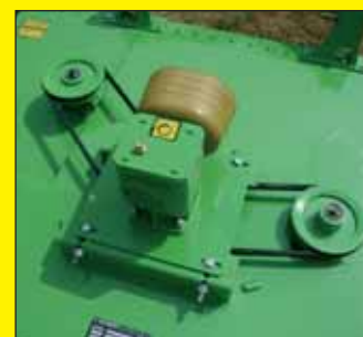
La trasmissione viene garantita da 2 cinghie trapezoidali che azionano i diversi rotori
