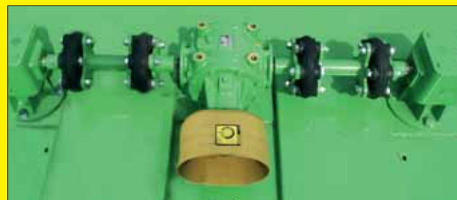
Trasmissione a quadrupla sicurezza a torsione
