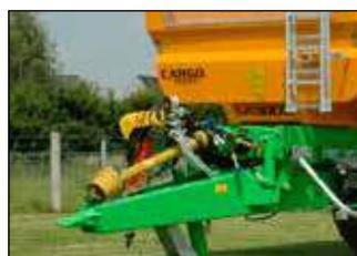
Trasmissione per presa di potenza
