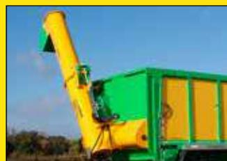
Un sistema di trasferimento può essere installato sul portellone posteriore del DRAKKAR. Due coclee, una orizzontale su tutta la larghezza del cassone e l'altra verticale, movimentano il materiale con un flusso di 450 t/h. Viene fornito un secondo portellone per l'utilizzo senza coclea.
