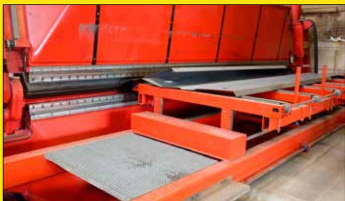
Piegatrice a controllo numerico con forza di pressione di 600 tonnellate
