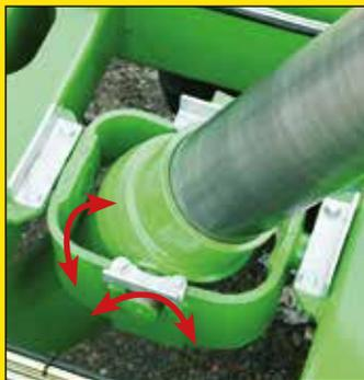
Quadrilatero a doppia oscillazione in cui si innesta il cilindro
