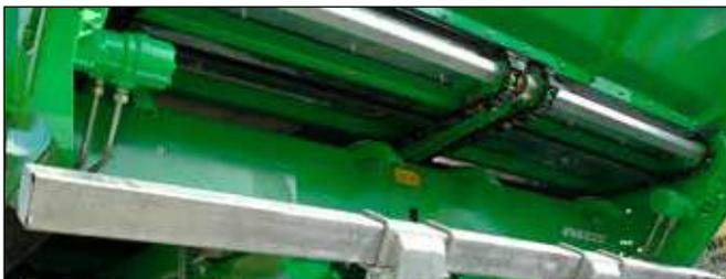
*Azionamento del fondo tramite due motori idraulici*
