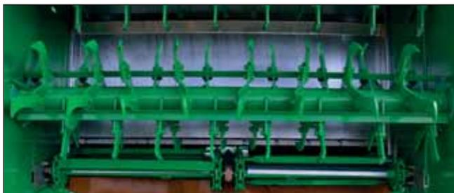
I due rulli frantumatori di diametro di 600 mm hanno una grande capacità di frammentazione sminuzzamento del materiale. Ne deriva uno spandimento di precisione di diversi prodotti.
