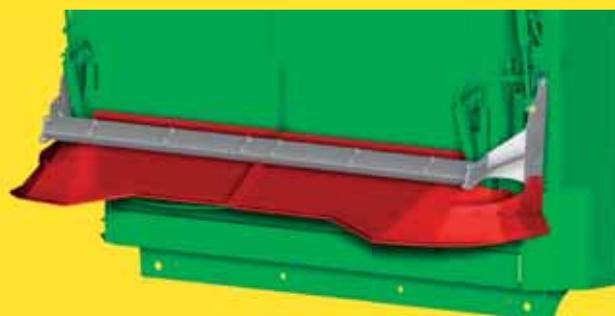
Per lo spandimento lungo il bordo del campo, è possibile dotare gli spanditori JOSKIN di un alettone sul bordo sinistro e/o destro comandato(i) in modo idraulico e separatamente.
