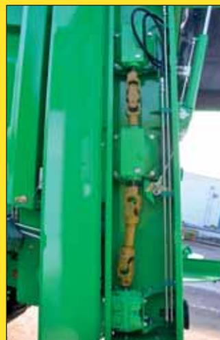
La trasmissione è interamente cardanica (1000 giri/min) e muove i rulli frantumatori ad una velocità di rotazione di 550 giri/min.
