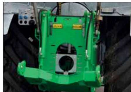
Sollevatore L600 su COBRA (fissato da 4 assi conici per ottenere un sistema assemblato robusto)
