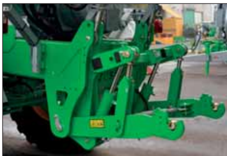
Sollevatore Lift integrato (sollevatore completamente integrato al telaio) su QUADRA, X-TREM, VOLUMETRA, TETRAX e EUROLINER
